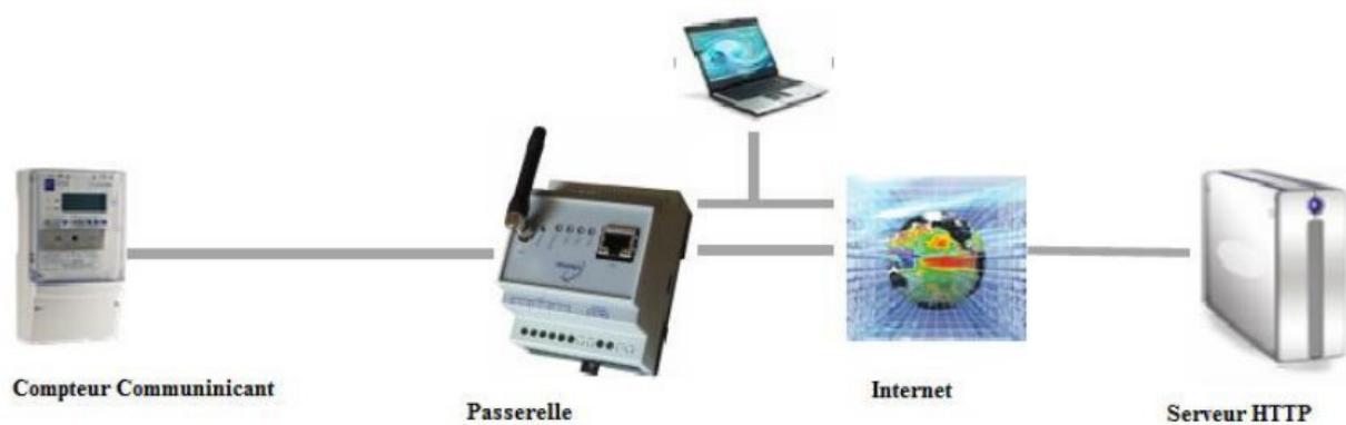
Figure 4 : Liaison de données d'un compteur communicant
