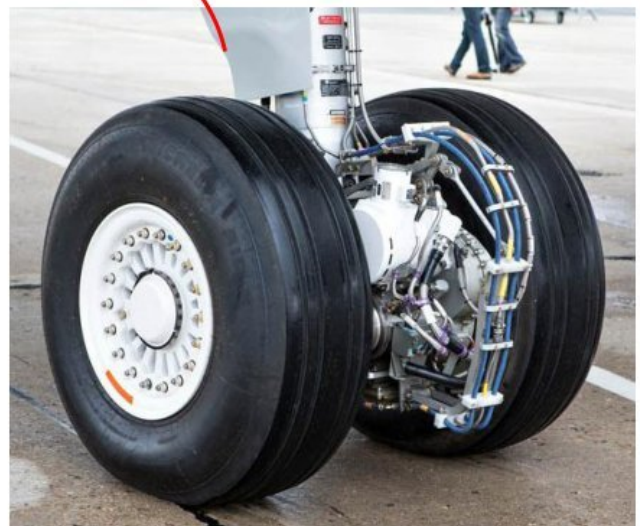
Prototype de l'EGTS monté sur un train d'atterrissage principal
