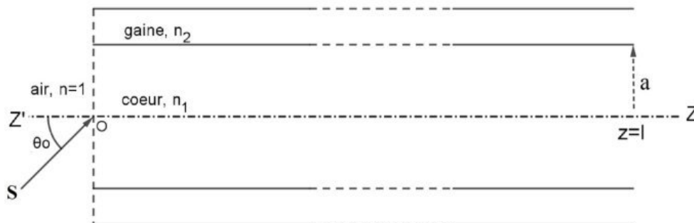
Figure 2 – Propagation de rayons dans une fibre optique
