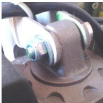
Photo 10 : liaison pivot S_0-S_1
