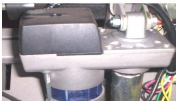
Photo 11 : actionneur d'inclinaison du support
